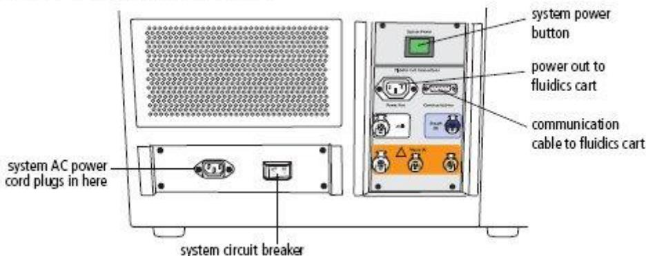
系統只需由一條電纜供電給儀器、雷射器、和液流系統車，該電線插頭直接插入了一個標準的室內電源插座；不需要其他特殊的設備。按下電源主開關，則啟動了該儀器和液流系統車。我們建議串聯使用一個連續供電系統，在電力不繼時維持儀器電能。
