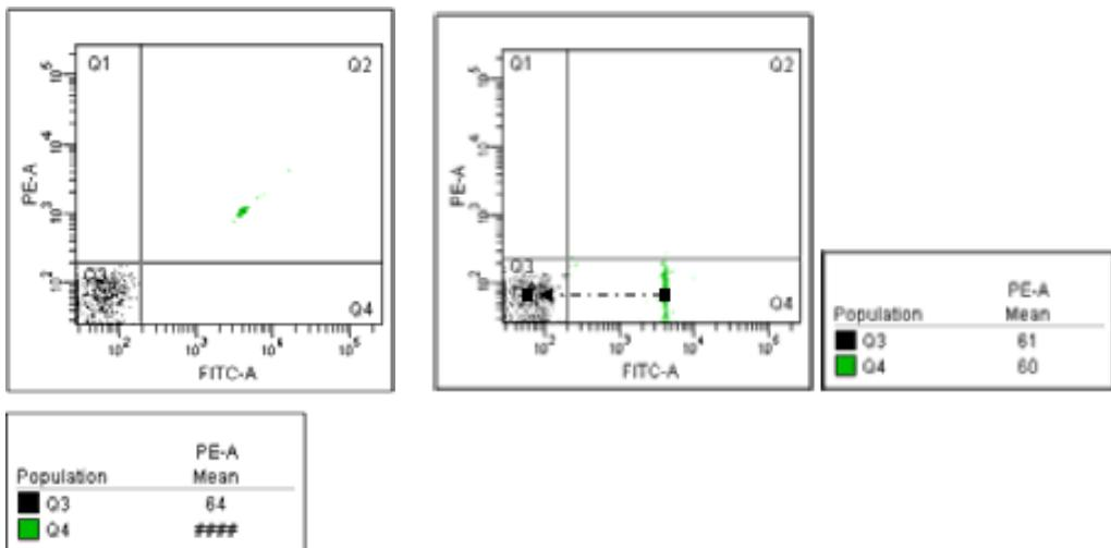
18 將 PE 對照管裝入載樣埠。先確認瀏覽器中，綠色的獲取指示 ( ) 位於 “Tube\_001” ，單擊 “Basic Controls” 視窗裏的 “Acquire” 鍵。調整 FITC-%PE 數值，使 unstained(Q3)與 PE alone(Q1) 的 FITC-A Mean 值相當，如下圖。
