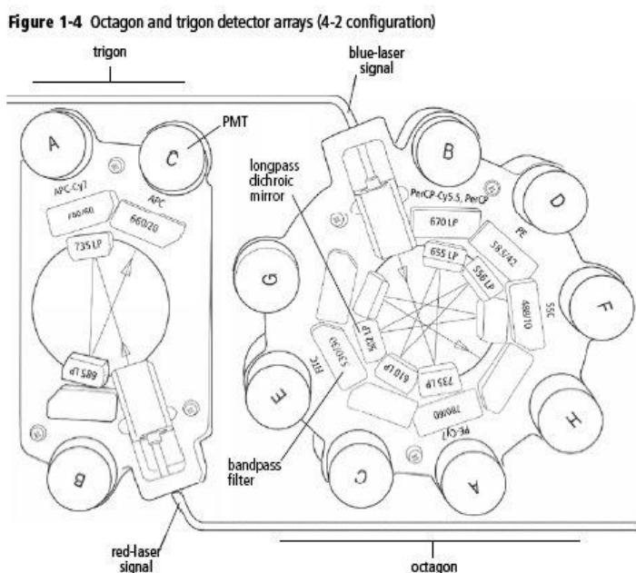
信號收集系統被設計成八角形和三角形的排列，這種設計可有效地從每一個雷射器中檢測光信號。具體如下：通過一組長通二分鏡 Longpass DM，先將螢光信號中波長最長的傳輸到第一個光電管（PMT）上，反射回來的較短波長的光信號則向下一個 PMT 方向發射。每一個 PMT 之前的帶通濾光片 bandpass 允許對所需收集的光譜波長做精細調節。如圖示，Blue A (750~810 nm)、Blue B (670~730nm)、Blue D (564~606nm)、Blue E (515~545nm)、Blue F (488nm)。
