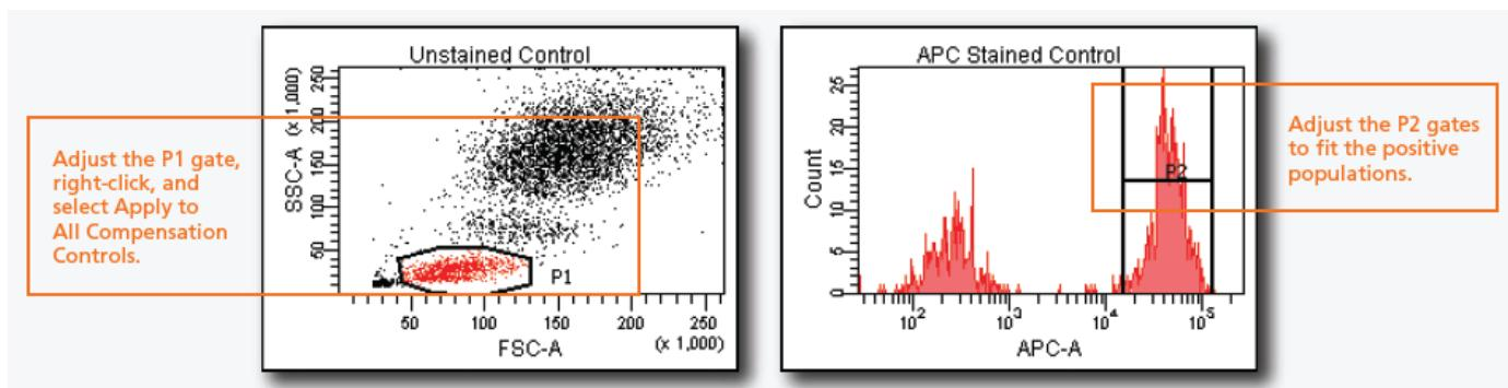
28 點擊 Experiment > Compensation Setup > Calculate Compensation。
