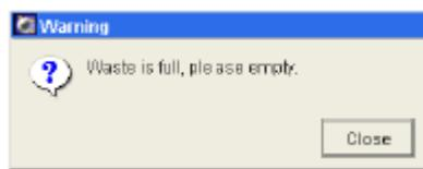
請在此時依指示充填或倒除溶液。假如這 FACSFlow 槽完全變空 (0%) 的，或者這廢物槽充滿溢流 (>99%)，整個儀器系統會自動暫時關閉。你仍將需要依指示充填或倒除溶液，方可繼續。
