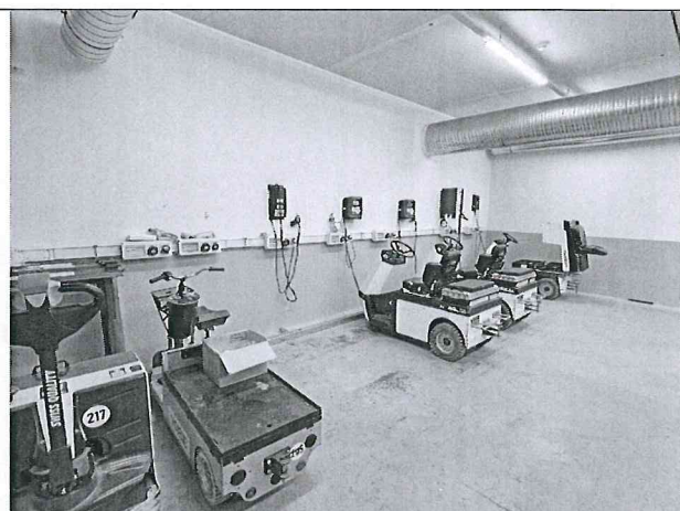
設有多輛電動曳引車供人員拖運廢棄物
