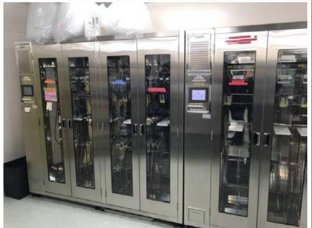
日本第一座全自動噴射式超音波洗滌手術器械裝置
