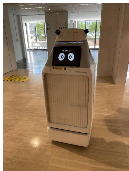
圖九、藥品自動化運輸機器
