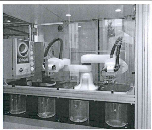
圖 38. 吧檯雙臂 SCARA 機器人「duAro2」
