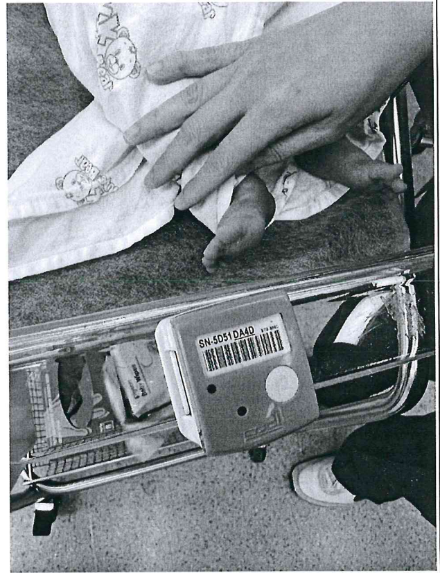
防止嬰兒失竊裝置，嬰兒腳圈及嬰兒車互相配對，若嬰兒腳圈未消磁，離開太遠會警示
