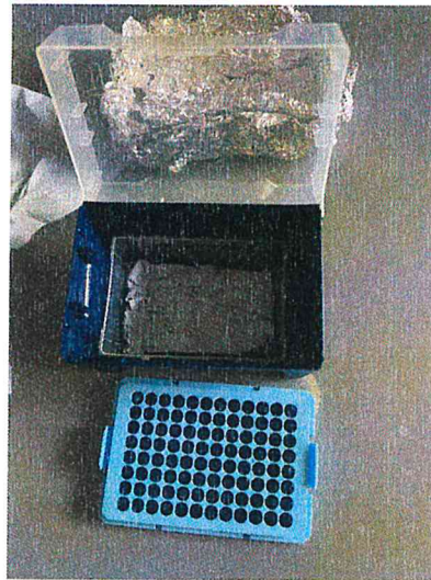
自製 humidity box 裡面放入 lab tissue 並加入 DECP treated water
