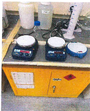
實驗室的電磁攪拌器 magnetic stirrer 及示意圖
