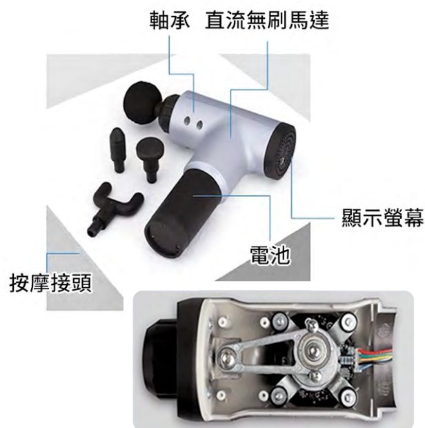
▲ 筋膜槍「基本結構組成」示意圖
