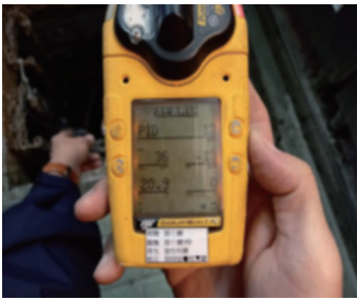
▲ 經消防局灑水稀釋污水槽內濃度，仍測得硫化氫:36ppm。
